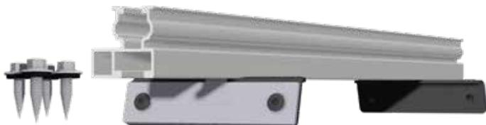
Afin d'obtenir une liaison équipotentielle continue, nous vous recommandons de raccorder les pièces de profilés avec un **ruban de mise à la terre en aluminium (N° art. 119015-002)** et respectivement une **vis pour tôles fines (N° art. 943000-360)**.
